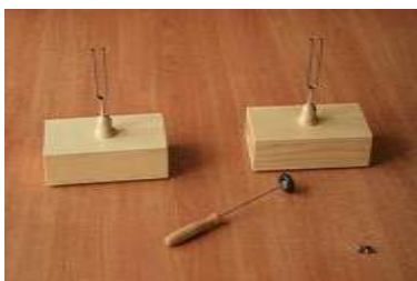
Kamertony w układzie rezonansowym
